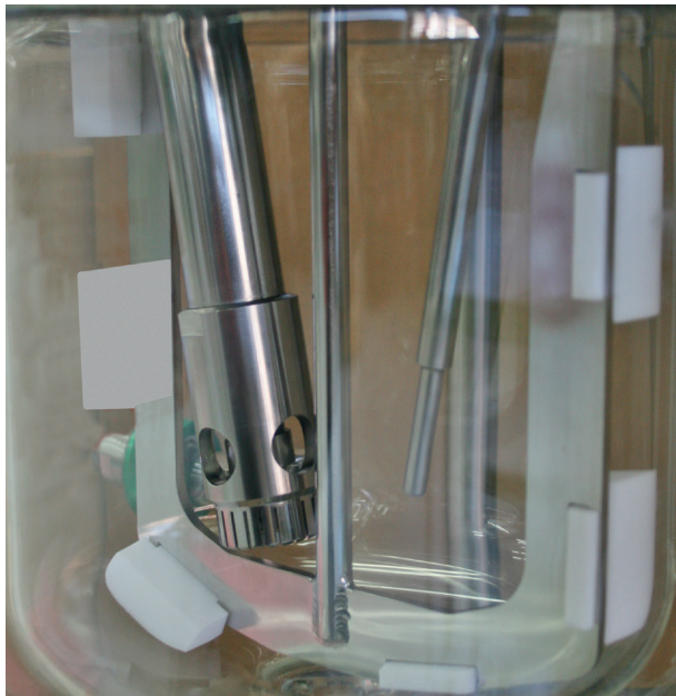
Dispergier-Aggregat, PTFE-Ankerrührer und Temperatursonde
